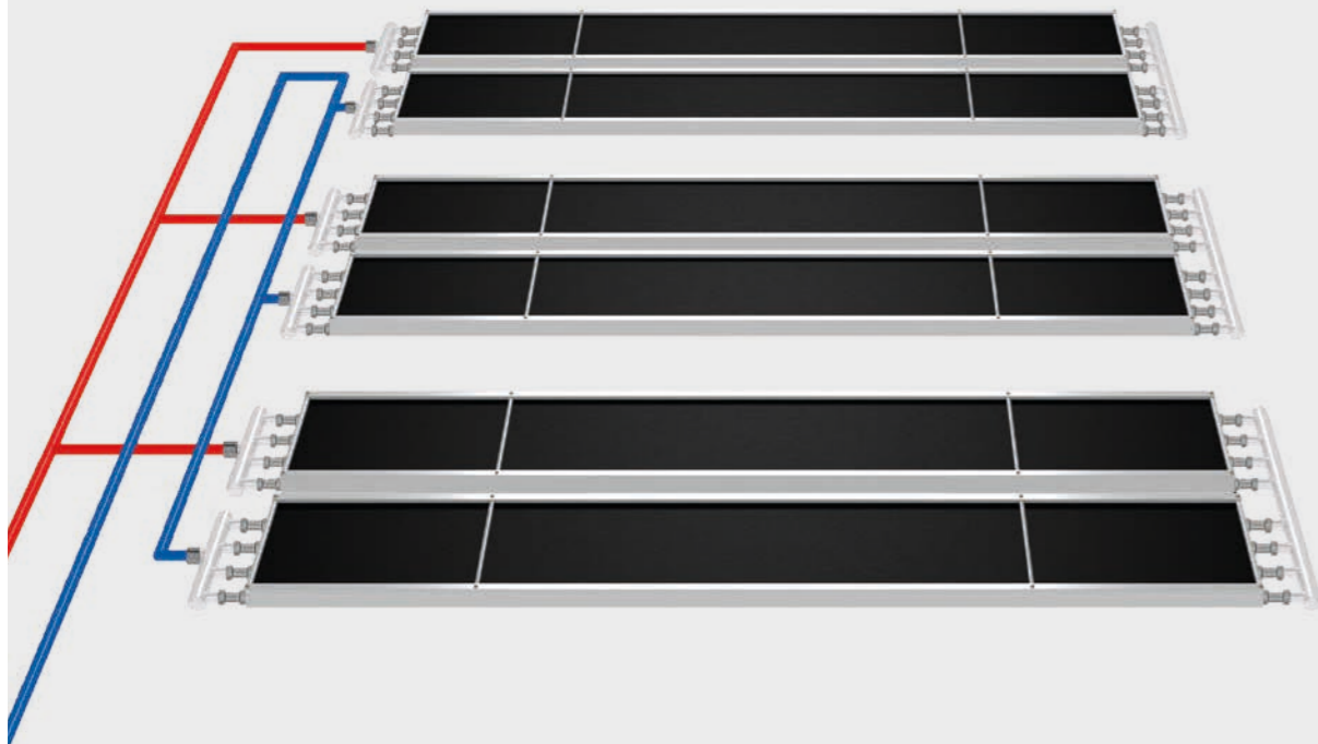
Fig. 1 : Disposition des tubes selon le système Tichelmann
